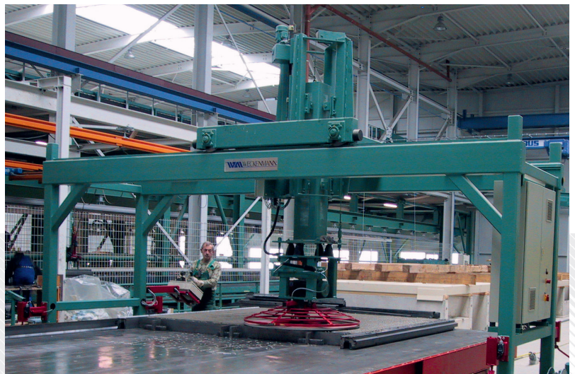
Höheneinstellung an Glättmaschine
